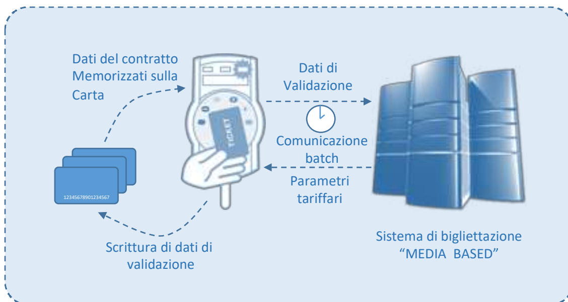
Figura 2 - Schema logico di funzionamento di un Sistema di Bigliettazione Elettronica "Media Based"
